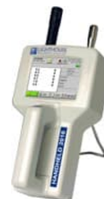
Bild. Till vänster ses partikelmätaren DustTrak modell 8520 i utomhusväska vid mätning i yttre miljö. Till höger ses partikelmätaren Lighthouse 2016.
