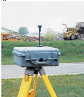
Bild. Till vänster ses partikelmätaren DustTrak modell 8520 i utomhusväska vid mätning i yttre miljö. Till höger ses partikelmätaren Lighthouse 2016.
